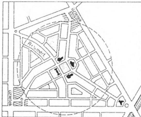
15. Clarence Perry amerikai építész sémája 1928-ból a szomszédsági egység kialakításának elvéről. Az egység belső úthálózata nem teszi lehetővé átmenő forgalom kialakulását.
