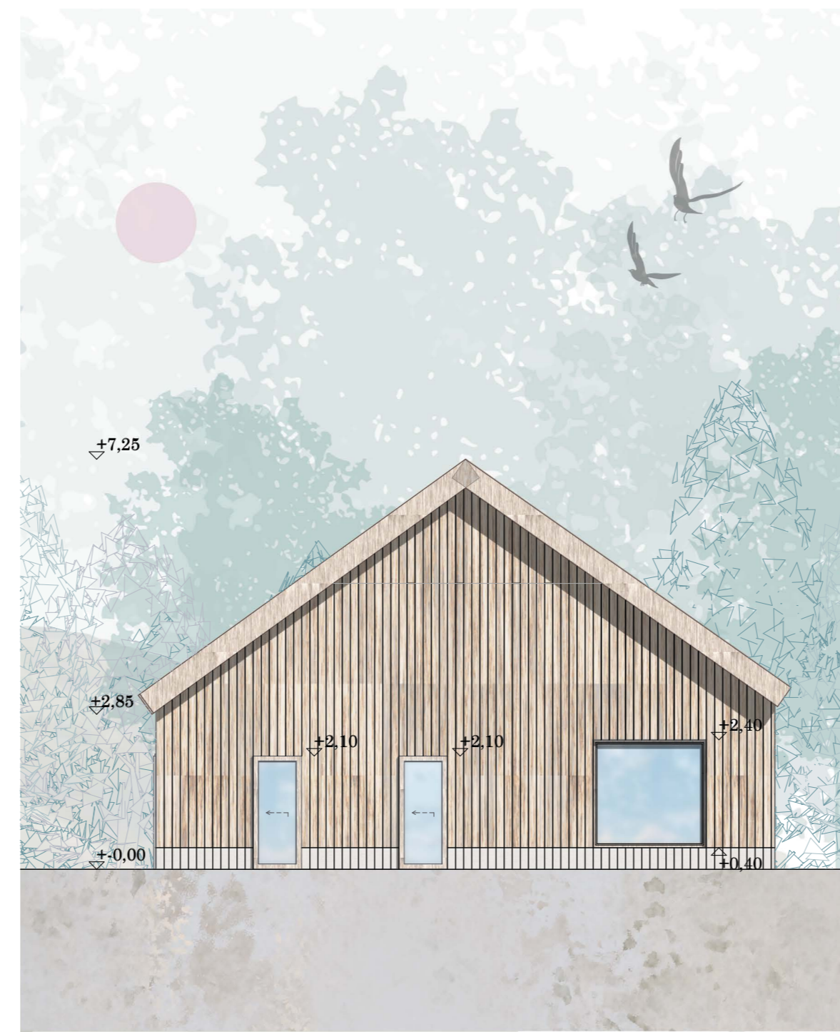
Kávézó homlokzatrajza Északnyugati homlokzat M = 1:100
