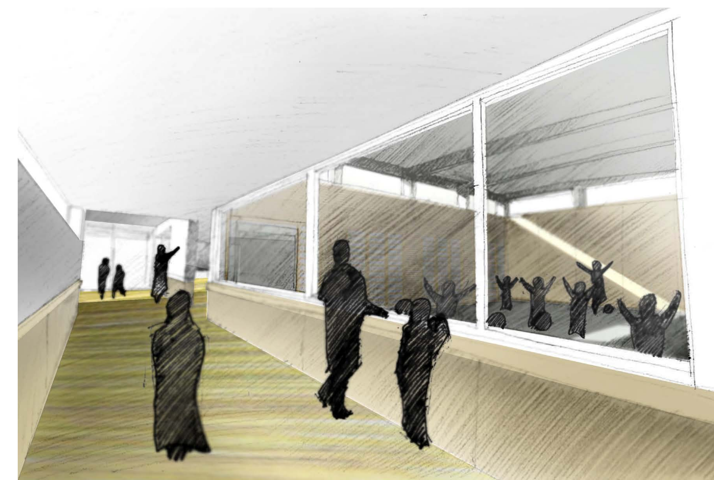
ÖSSZEKÖTŐ FOLYÓSÓ AZ ELŐTÉR FELÉ NÉZVE, BELÁTVA A TORNATEREMBE fényjáték - folyosó udvar felőli oldalán ablaksáv a födém alatt, a tornaterem így a folyosó felől is természetes fényt kap
